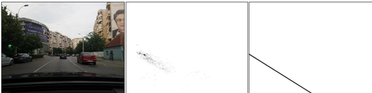
Figura 2.5. Stânga: imaginea de intrare, centru: acumulatorul Hough, dreapta: linia extrasă din acumulator.
