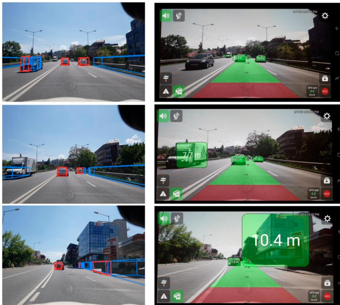
Figura 3.9. Comparație detecție vehicule cu o abordare bazată exclusiv pe rețele artificiale. În coloana din stânga este abordarea noastră, în coloana din dreapta este sistemul UGV Driver Assistant.
