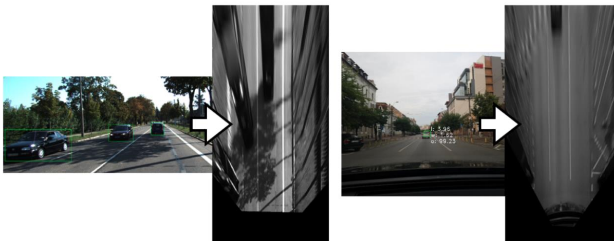
Figura 2.10. Generarea imaginii “bird’s eye view” folosind parametri calculați din calibrare.
